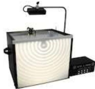
En filmant l'écran dépoli avec une webcam, on réalise la captation de la progression du front du paquet d'ondes.
