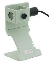
Pour émettre et recevoir des ultrasons, on utilise des transducteurs piézoélectriques qui vont transformer un signal électrique en une vibration acoustique et vice-versa.
