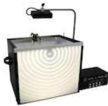
En filmant l'écran dépoli avec une webcam, on réalise la capture de la progression du front du paquet d'ondes.
